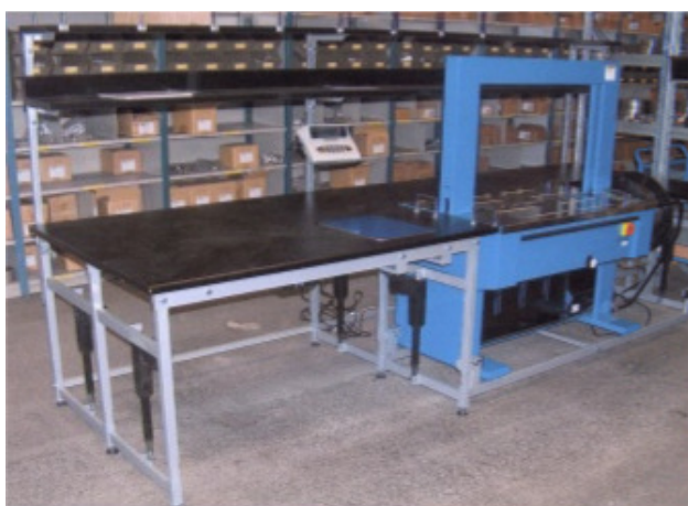
SumoLine med indbygget omsnøringsmaskine model AutoPak Eco. Den viste opstilling måler 330x110 cm, og kan løfte op til 1200 kg. Derudover er der nedfældet vægt i bordplade og display på stolpe.
